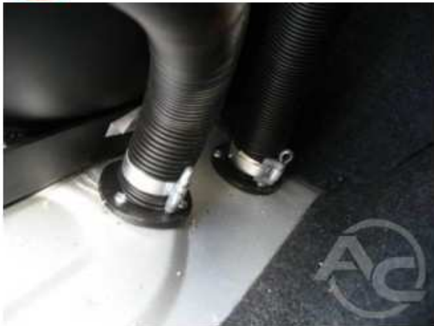
Obr. 1.3.16 Kabelová chránička připojená k průchodce vyvedné vně vozidla
