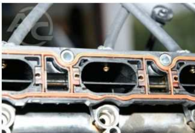
Obr. 1.3.34 Umístění trysek (pohled zevnitř sacího potrubí)
