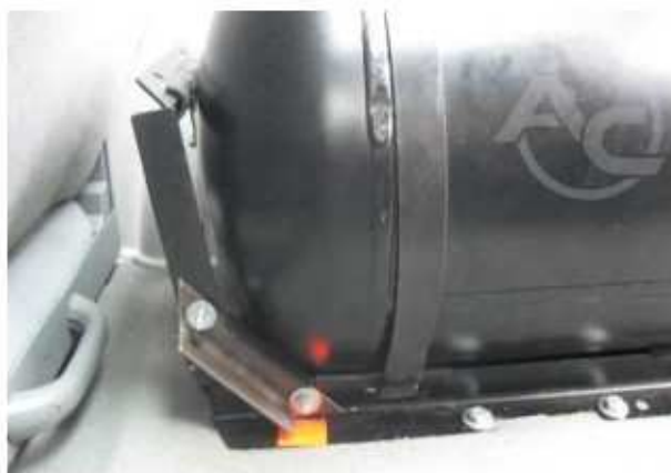
Obr. 1.3.9 V případě válcové nádrže namontované rovnoběžně s podélnou osou vozidla musí být namontován prvek držáku tak, aby byl zamezen pohyb nádrže vpřed.
